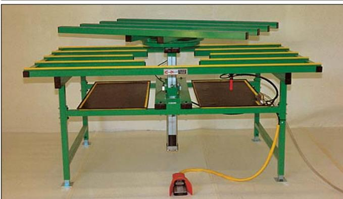
Mit integriertem Dreh-Hebetisch, stufenlos von 850 - 1250 verstellbar. Drehbewegung über Drehkranz, mit Fußventil feststellbar.
