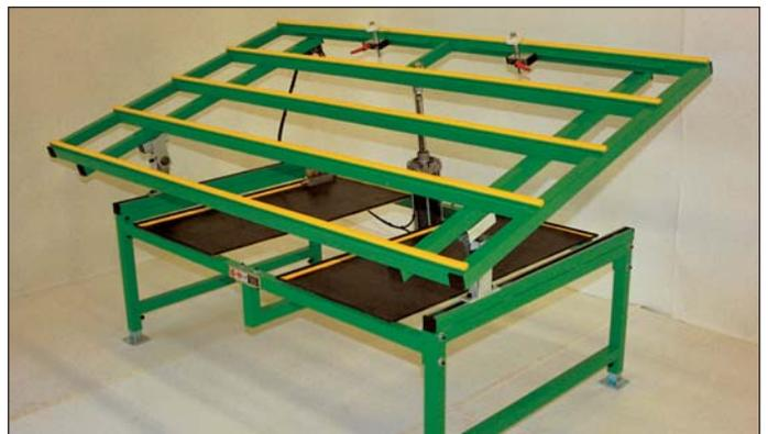
**Schiebearbeitstisch mit Dreh-Hebeeinrichtung
